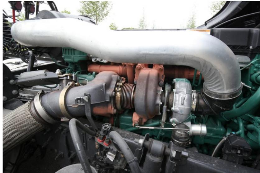
Die Turbocompoundturbine nutzt die Restwärme des Abgases und sorgt für zusätzliche Kraft
