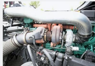
Turbocompound-Turbine rechts am Motor
